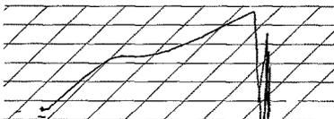
Abb. 6. Kraftdehnungs-Diagramm eines menschlichen Kopphaares. Versuchsbedingungen hier und in den folgenden Abbildungen: Reißstrecke 30 mm, Zerreiẞdauer 20 sec. Die 45° geneigte Ordinatenführung entspricht einem dehnungslosen Versuchsablauf. Die am Kurvenende auftretenden Striche rühren von Nachschwankungen des Schreibhebels her
